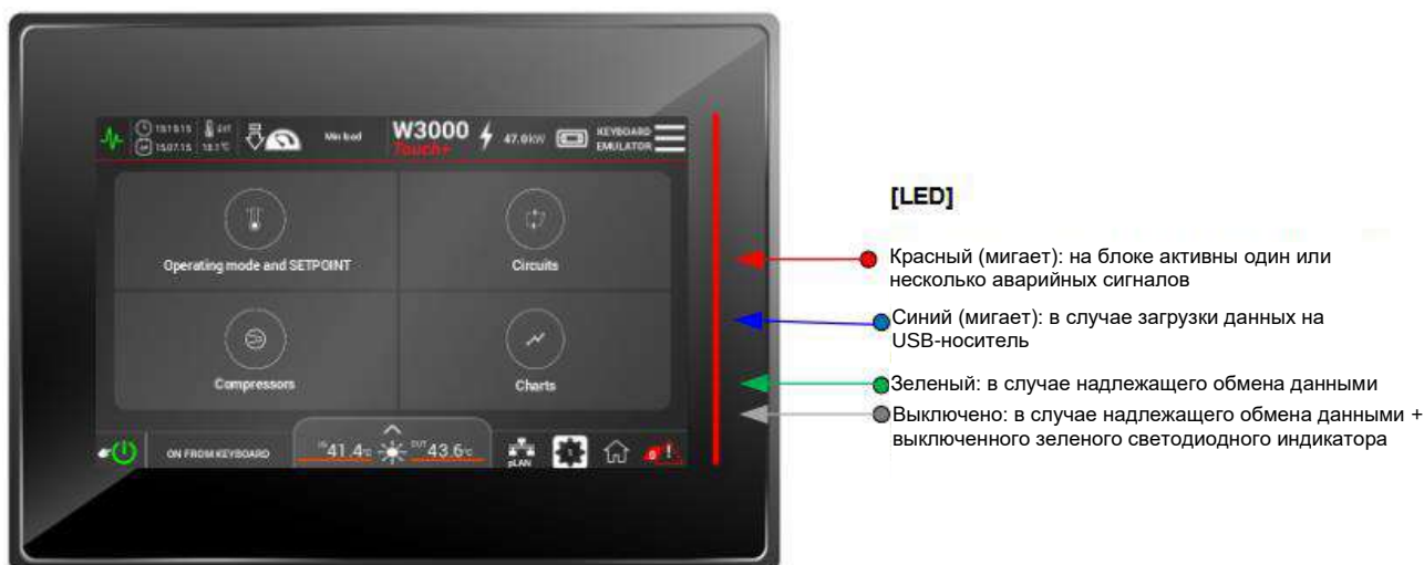
Рисунок 2-8: Значение различных элементов на клавиатуре W3000Touch+ 7 дюймов.
