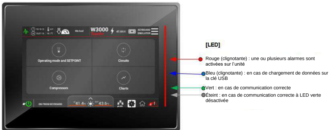
Figure 2-8: Signification des différents éléments du clavier W3000Touch+ de 7".
