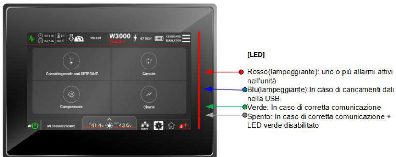
Figura 2-7: Significato dei vari elementi nella tastiera W3000Touch+ da 7".
