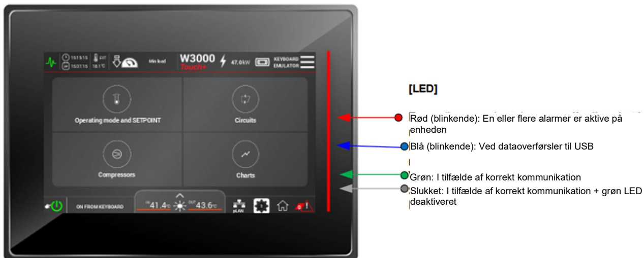
Figur 2-8: Betydning af de forskellige dele i tastatur W3000Touch+ på 7".
