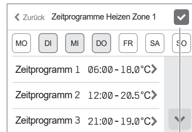
[Zeitprogramm Heizbetrieb Z1] Bearbeiten
